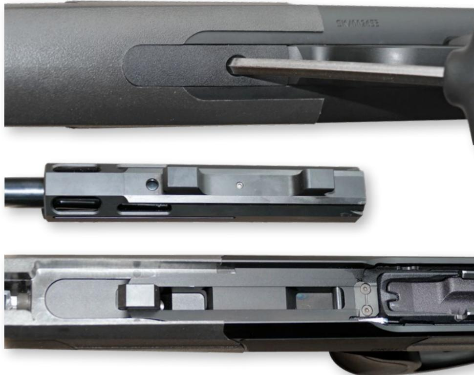
Durch die schräg angesetzte Schraube am Vorderschaft (o.) werden die beiden Nasen des Austauschlaufs (Mitte) in die Aussparungen im Systemkasten (u.) gezogen. Prismenförmige Anlageflächen links und rechts garantieren unverrückbaren Sitz.
