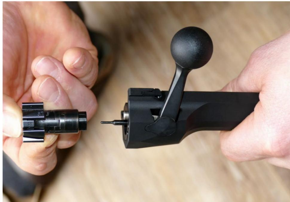
Der Verschlusskopf ist entnehmbar. Dazu muss nur der Auszieher nach außen gedrückt werden. Gut sichtbar ist dann der herausragende Schlagbolzen.
